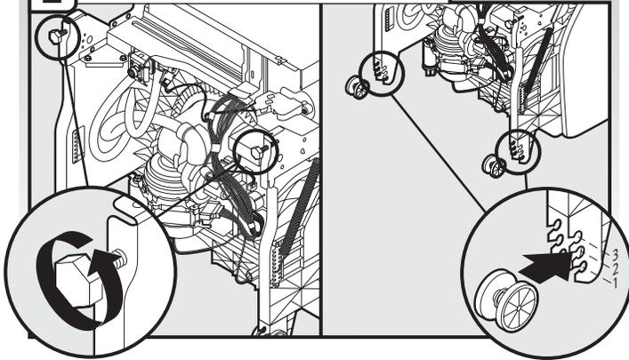
Ajuster (vissage) les deux pieds de réglage de l'aplomb à la même hauteur. Placer les roues à la position nécessaire selon les indications du "Tableau de réglage - Hauteur du lave-vaisselle". (Pour modifier la position des roues, utiliser un tournevis à lame plate pour enlever la roue; réinstaller la roue à la nouvelle position choisie (emboîtement).)
